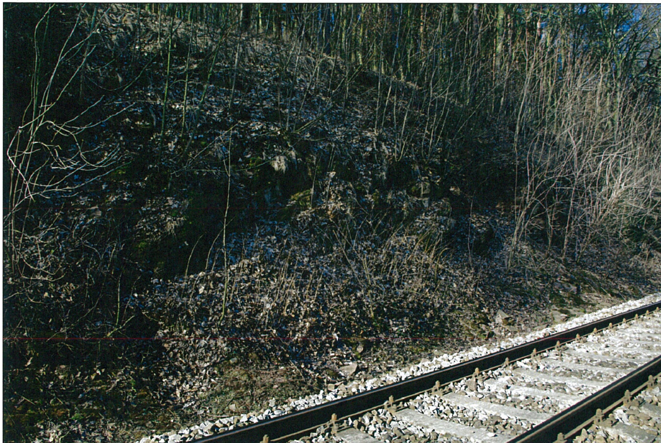
Foto – 5 Pohled na levou stranu svahu v km 9,070 s odkryvem pískovců s polohami prachovců ve spodní části.
