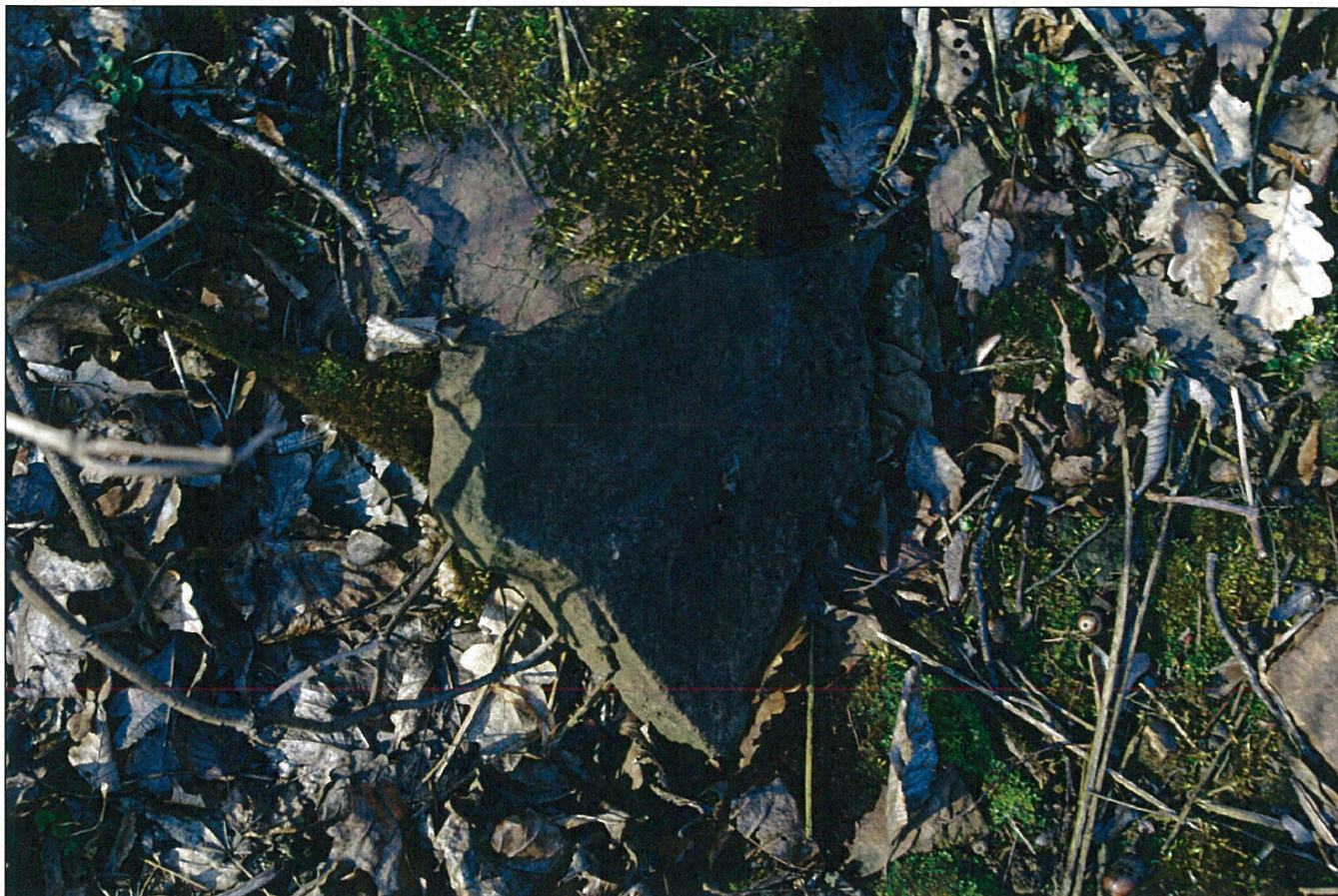
Foto – 7 Pohled na fragment vypadlého pískovce s deskovitou odlučností u paty svahu v km 9,075. Velikost cca 60 cm.
